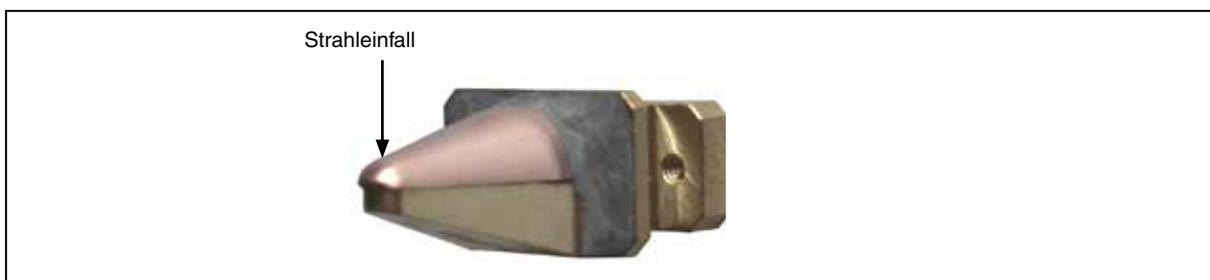
Abb. 5.4: Orientierung der Messspitze beim Einbau
