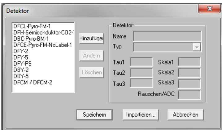
Abb. 11.2: Dialogfenster für das Anpassen von CO<sub>2</sub>-Halbleiterdetektoren
