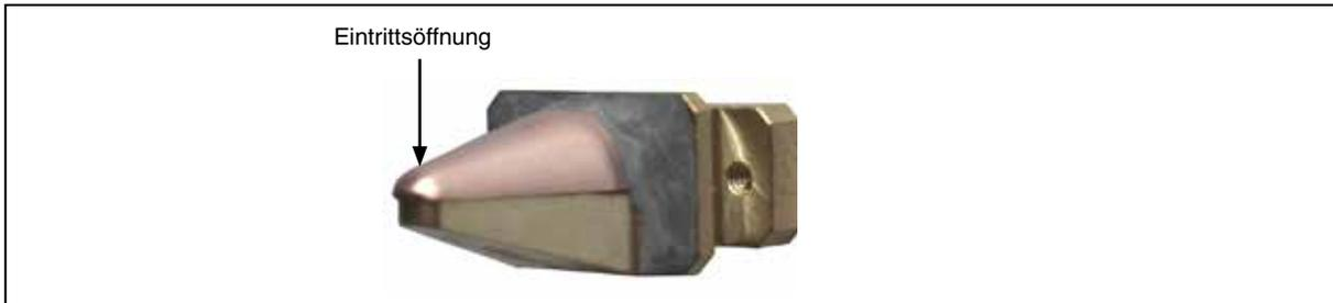
Abb. 15.4: Eintrittsöffnung (Pinhole) in der Messspitze
